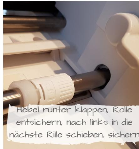
Hebel runter klappen, Rolle entsichern, nach links in die nächste Rille schieben, sichern
